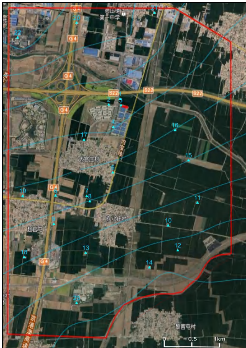
图 5.4-5 丰水期地下水水位监测（水位等值线图）
